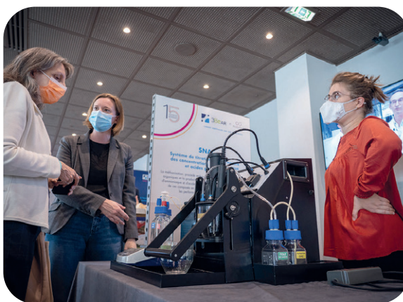
Cap'CARNOT. Système de titration pour la mesure des concentrations en ammoniacque et acides gras volatils. Partenariat Carnot 3BCAR - Entreprise BioEntech.
